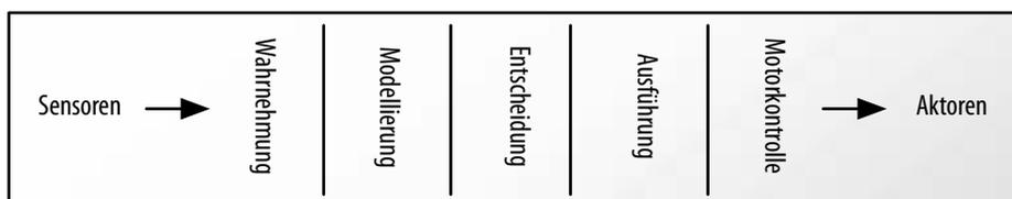
Abbildung 2.2.: Subsumption-Architektur: Traditionelle Dekomposition der Robotersteuerung in funktionale Komponenten. (Nach [Brooks 1986](#), Fig. 1)
